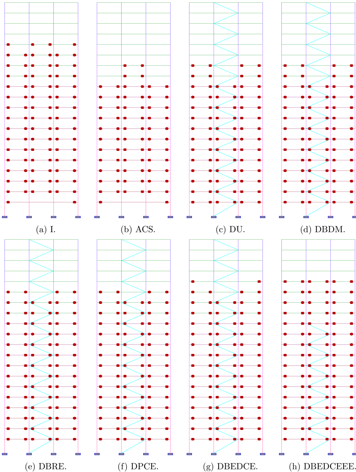
Figura 4.17: Estado de daño del marco 20N
